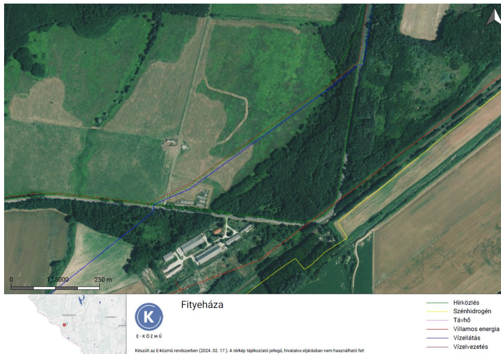
12. számú ábra: Fityeháza – meglévő közművek nyomvonala
